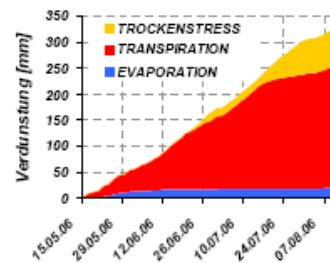
Ableitung von Perioden des Wasserstresses aus HYDROLYS-Messungen und METEOLYS – Berchnungen als Basis für die Ks - Bestimmung
